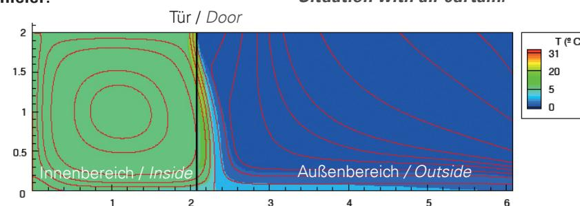
Der Luftstrom des eingebauten Türluftschleiers schottet deutlich den warmen Bereich vom kalten Bereich ab. Der Türluftschleier hält die innere Umgebung auf einer behaglichen Temperatur und vermeidet, dass die kalte Luft von außen eindringt. In dieser Situation spart der Türluftschleier mehr als 80% der Energie, die für die Erwärmung des Innenbereichs verwendet wird.
